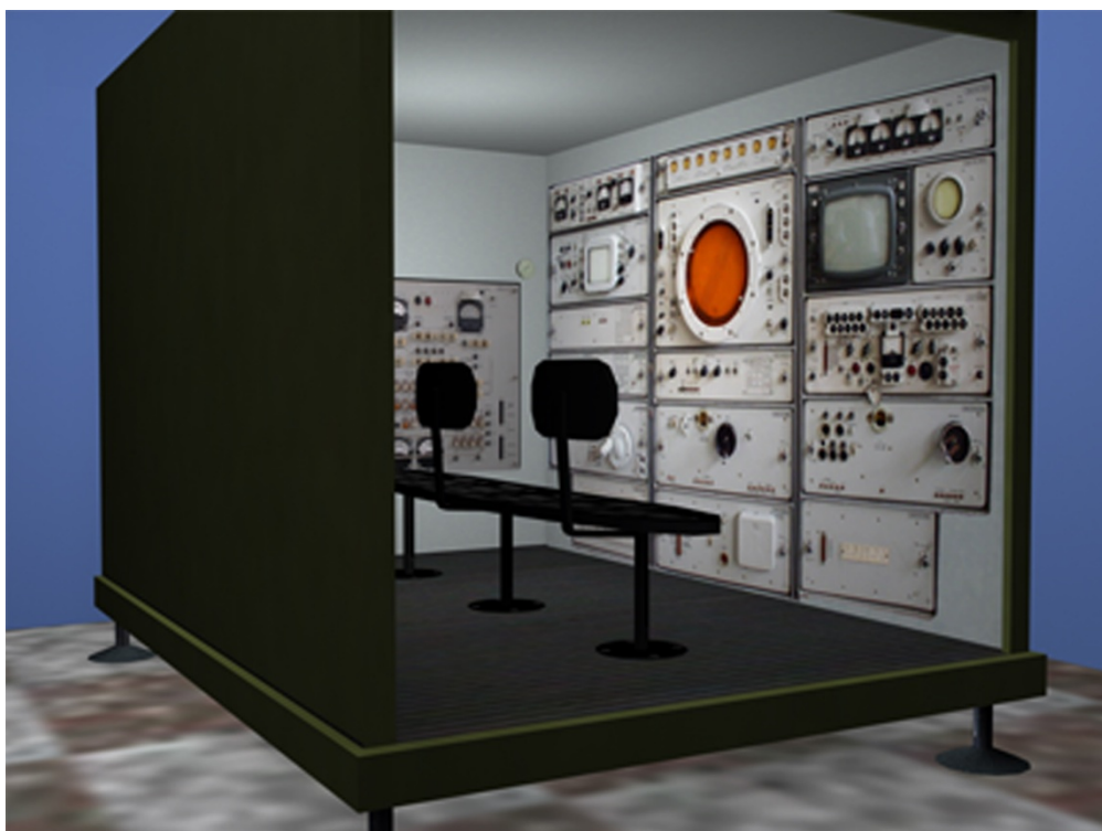
Общий вид имитатора боевого отделения БМ 9А33БМЗ
